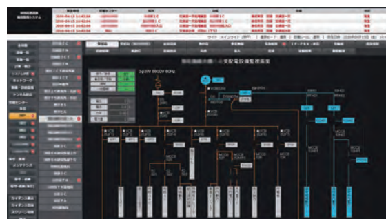
(事例より) 受配電設備監視画面例 ビル、照明、エレベータ、所内電灯、防災・保守などへの受配電設備を系統図で監視しています。
