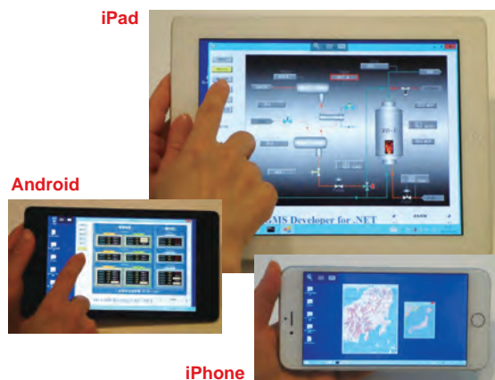
Windows Server 2019 を使い、コンパクトで高速な SL-GMS をリモートデスクトップでシンクライアント運用し、モバイルから閲覧操作
