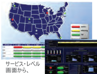
DCIM (データセンター・インフラ管理) : ITインフラを支える物理インフラ層からサービスの状況、サービスに影響する気象などの情報までを一元監視
