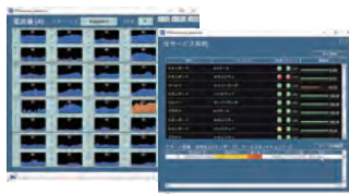
DCIM (データセンター・インフラ管理) : ITインフラを支える物理インフラ層からサービスの状況、サービスに影響する気象などの情報までを一元監視
