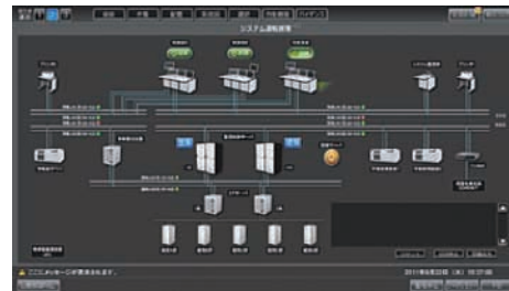
「システム運転管理」 監視制御システムを構成する機器状態を監視する画面
