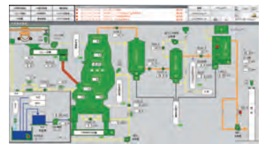
荏原環境プラント (株) 様 ご開発 [事例より] ごみ焼却施設における監視制御システム
