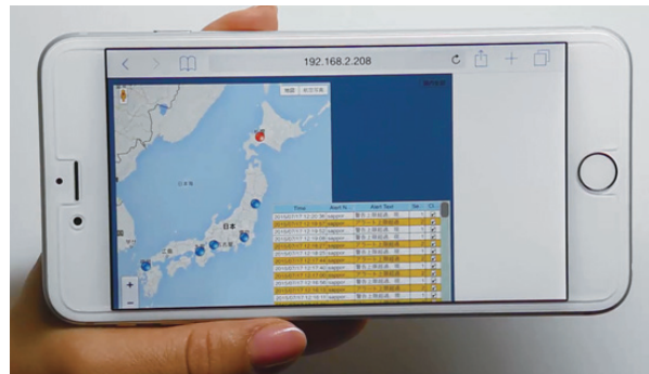
RTViewのディスプレイサーバによって iPhoneでブラウザ運用される高対話性のWebシンクライアント
