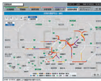
(株) 東芝 様 都市内高速道路交通管制システム
