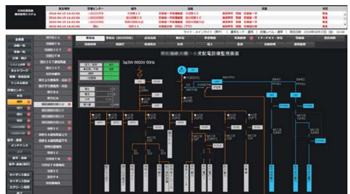
画面3. 受配電設備監視画面例
