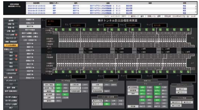
画面1. トンネルにおける防災設備監視画面例
